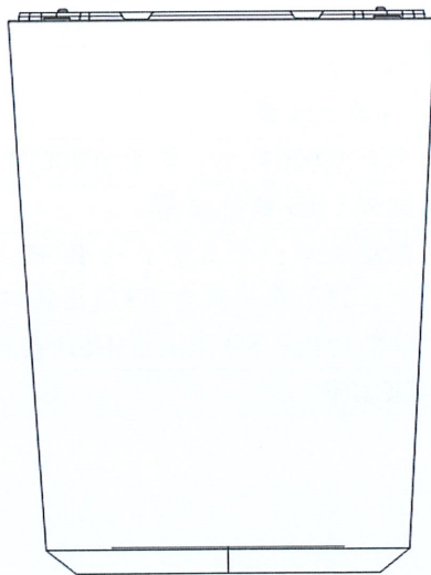
图 5.1 机壳示意图-材质铝合金-表面处白色喷油
